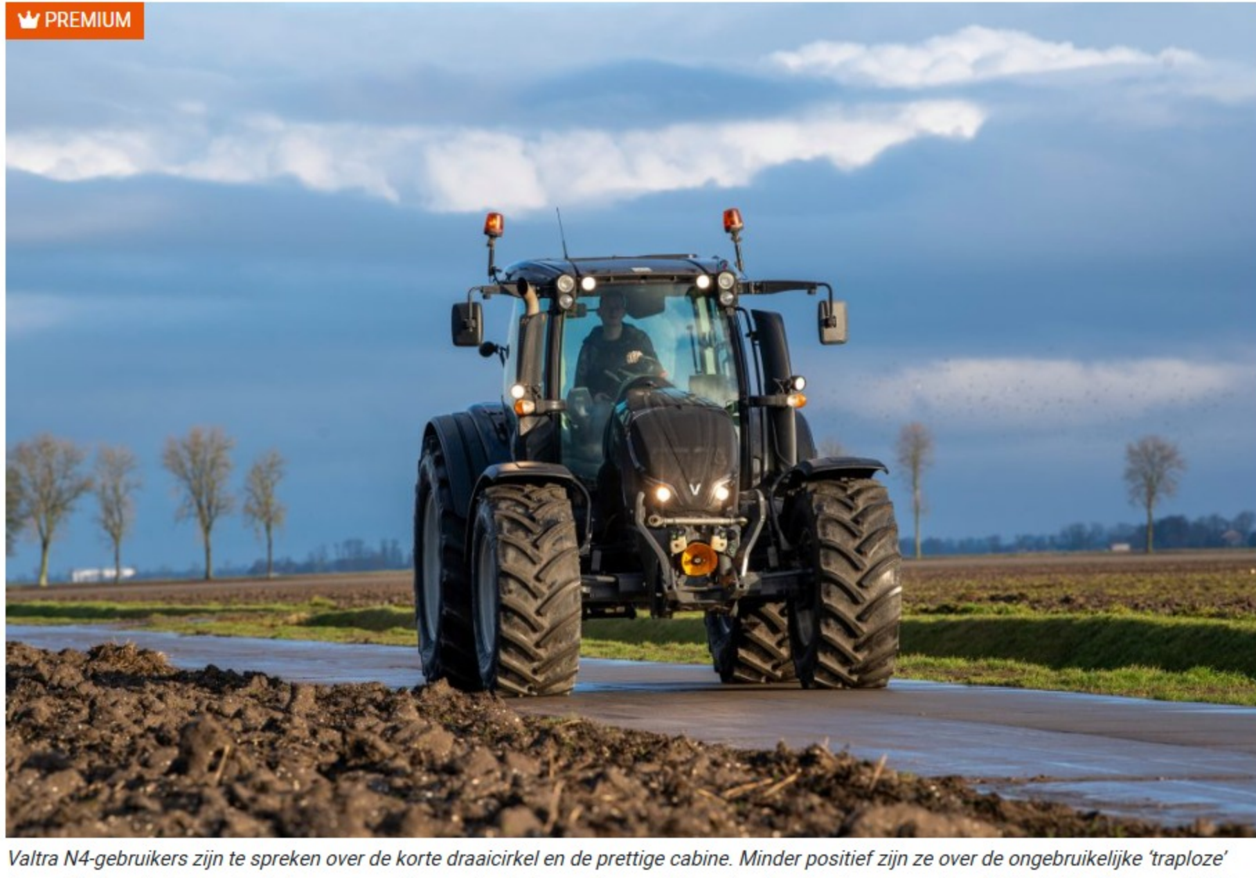
Valtra N4-gebruikers zijn te spreken over de korte draaicirkel en de prettige cabine. Minder positief zijn ze over de ongebruikelijke 'traploze' transmissie met vier mechanische groepen. De meeste storingen die gemeld worden, houden daarmee verband. Foto's: Mark Pasveer / Video: Paulus Maessen
