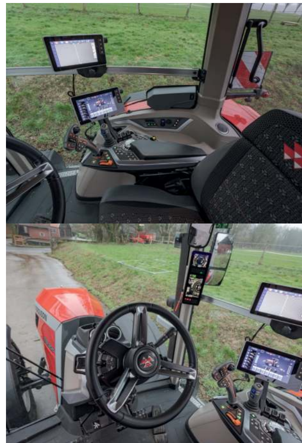
Boven: het beeldscherm heeft een fijne weergave en het is nu mogelijk er een tweede bij te bestellen. De armleuning is ergonomisch, al konden wij het niet zo goed vinden met horizontaal geplaatste diepteregeling van de hef. Onder: een smalle motorkap, en een zeer goed afleesbaar scherm in de A-stijl.
